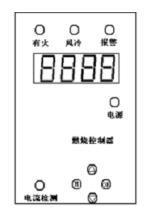
分别为有火、风冷、报警。这三个指示灯下方是由 4 位数码管组成的显示区,数据显示和参数设置都通过它来显示。数码管显示区下方有一个电源指示灯。面板左下方有一个电流检测孔,为标准 5 毫米耳机插孔,可以外接微安电流表检测火焰传感器反馈的电流大小。面板右下方有四个功能设置按键用于参数设置。按设置键将进入相应的参数设置状态中;中间两个为加减键,对参数值做加减操作;左边一个为菜单键,用于功能选择;右边为确认键,当设置完成时,按确认键保存新设定的参数。
